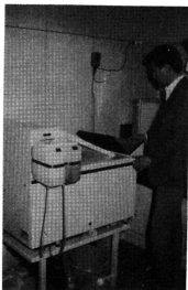
検査に威力を発揮するX線フィルム自動現像機
