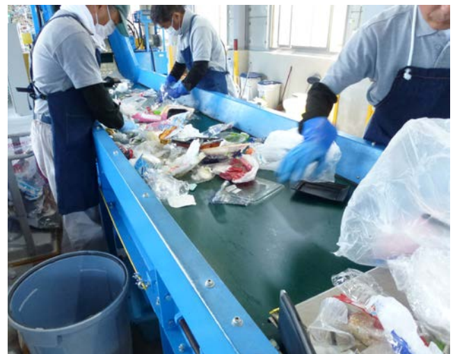
プラスチック類処理施設では手作業で選別しています
