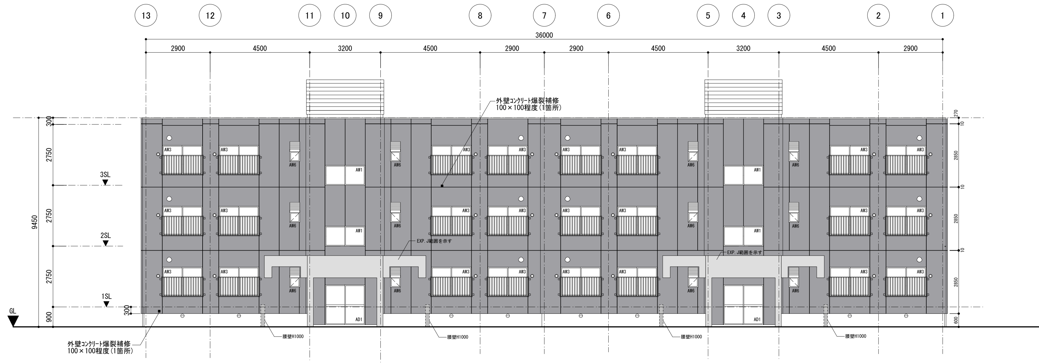
北側立面図(通路部なし) 1/100 ※外壁補修箇所は施工時に再調査し決定する
