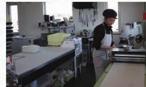
人気商品のクロワッサンは、生地を何重にも重ねるため、パイローラーを使って作業中。
