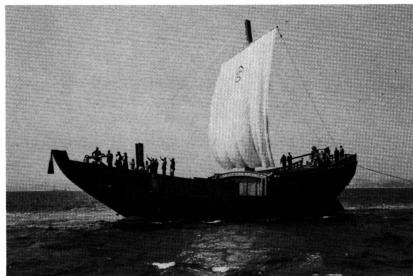
一世紀の時空を超えて寄港した北前船は、全長30m、幅9m、帆柱高20mの実物大の復元船です。
